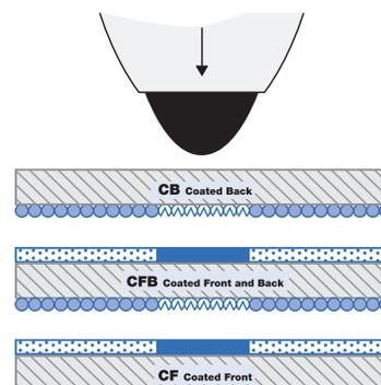
Durch den Schreibdruck zerplatzen die Mikro-kapseln. Die freiwerdende Reaktionsflüssigkeit erzeugt auf der Nehmerschicht des nächsten Blattes die Durchschrift.
